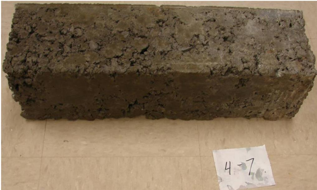
FIGURE 11. LAB 4 BEAM 7 VOIDS AND POOR CONSOLIDATION
